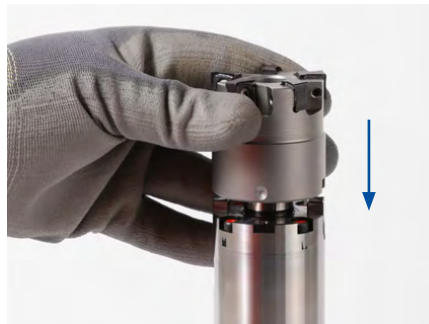
2. Den Fräseraufsteckdorn in eine Wechsellvorrichtung einspannen.
