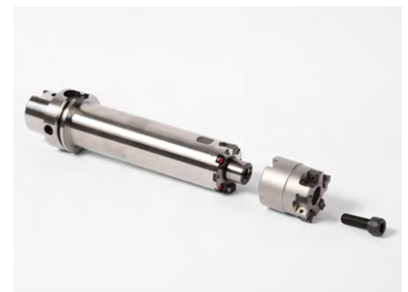
3. Das Werkzeug vom Fräseraufsteckhorn entnehmen.
