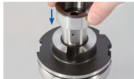
3. Nałożyć pierwszy pierścien dystansowy na trzpień frezarski nasadzany.
