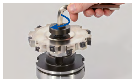
8. Dokręcić śrubę do mocowania frezu dalej w kierunku zgodnym z ruchem wskazówek zegara za pomocą klucza imbusowego, a następnie za pomocą klucza dynamometrycznego (moment dokręcania – patrz tabela „Moment dokręcania śruby do mocowania frezu”).
