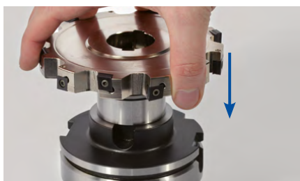
5. Umieścić narzędzie czołowo na trzpieniu frezarskim nasadzany.
