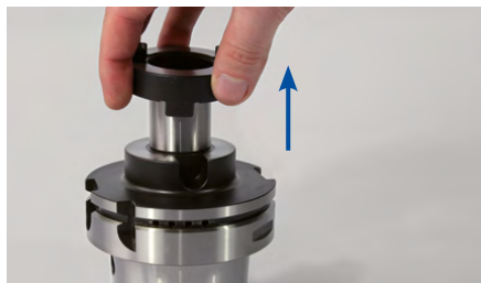
1. Zdjąć pierścien prowadzący z trzpienia frezarskiego nasazanego.
