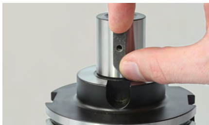
2. Włożyć wpust piórowy na trzpień frezarski nasadzany.
