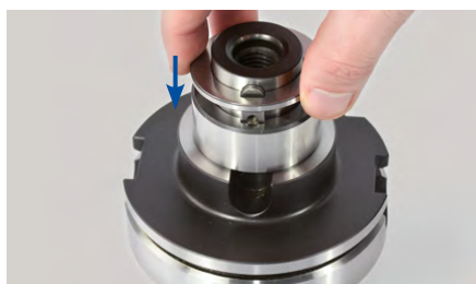
4. Nałożyć drugi pierścien dystansowy na pierwszy pierścien dystansowy i trzpień frezarski nasadzany.
