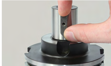
2. Colocar la chaveta en el portafresa.
