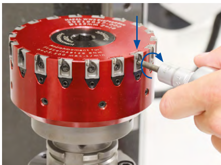
4. Presionar ligeramente el cartucho de fresar durante el apriete de modo que haga contacto la cuña de ajuste. Colocar el tornillo de sujeción** del cartucho de fresar y apretar con 1-2 Nm en el sentido de las agujas del reloj.
