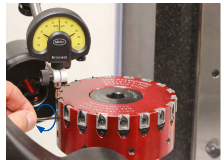
6. Posicionar el reloj comparador sobre el cartucho de fresar ajustado y poner a cero. Ajustar los cartuchos de fresar con el reloj comparador 0,01\text{ mm} antes de EM: para ello, girar el tornillo diferencial con una llave Allen en sentido de las agujas del reloj hasta alcanzar la medida cero.
