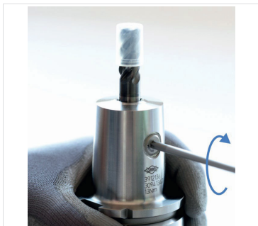
Abb. 5: Spannschraube mit Anzugsdrehmoment anziehen
