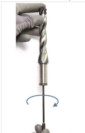
Abb. 12: Wechselbohrkopf durch Drehen im Uhrzeigersinn lösen
