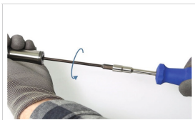
Abb. 11: Spezialspannschraube mit Anzugsdrehmoment anziehen
