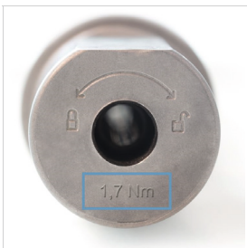
Abb. 10: Anzugsdrehmoment an der Unterseite des Wechselkopfhalters
