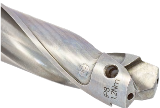
4. Inserire il nuovo inserto nella sua sede. Utilizzando la chiave TORX® PLUS in dotazione, stringere la vite speciale di serraggio ruotandola in senso orario.
