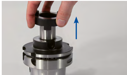
1. Togliere l'anello di trascinamento dal mandrino per fresa a manicotto.
