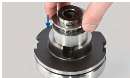
4. Inserire il secondo anello distanziatore sul primo anello distanziatore e sul mandrino per fresa a manicotto.
