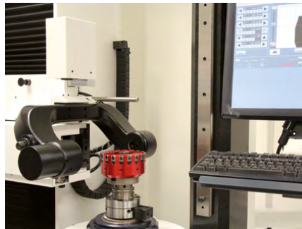
5. Utilizzare il dispositivo di regolazione per regolare otticamente la cartuccia di fresatura -0,01 mm prima del valore di impostazione EM. A tale scopo, rilevare il tagliente con il dispositivo di misurazione ottico e ruotare il grano a doppio effetto in senso orario, utilizzando una chiave a brugola, fino ad ottenere il valore EM = -0,01 mm. Per una regolazione meramente ottica ripetere questa procedura per le restanti cartucce di fresatura (quindi proseguire con il punto 7).
