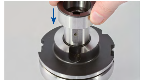
3. Inserire il primo anello distanziatore sul mandrino per fresa a manicotto.
