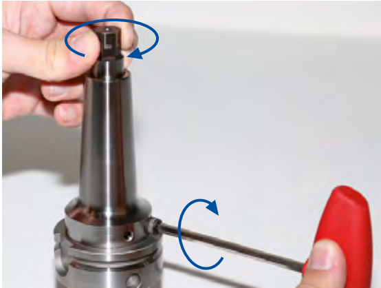
Abbildung 1: Spannschraube und Werkzeugprüfling drehen
