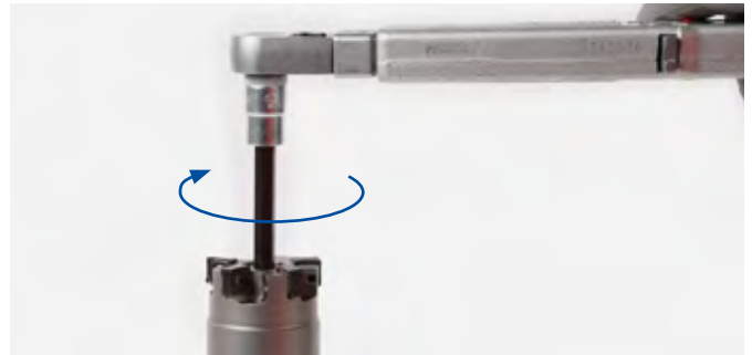
5. Einen Drehmomentschlüssel auf das vom Fräserhersteller geforderte Anzugsdrehmoment einstellen.
