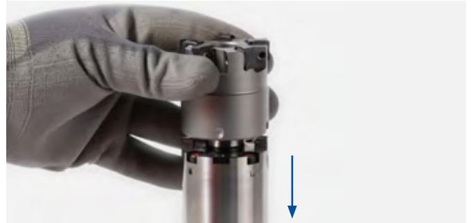
2. Den Fräseraufsteckdorn in eine Wechsellvorrichtung einspannen.
