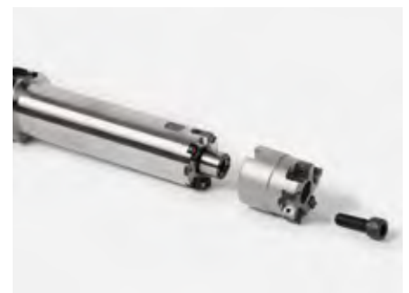
3. Das Werkzeug vom Fräseraufsteckdorn entnehmen.
