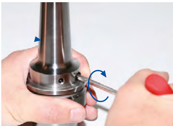
Abbildung 2: Spanschraube anziehen und Mindestumdrehungen beachten
