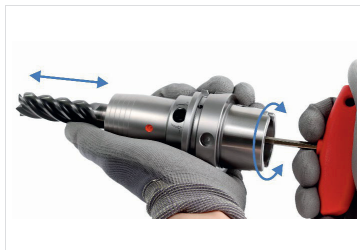
Abb. 9: Werkzeuglänge einstellen (axial)
