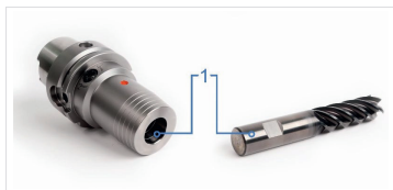
Abb. 7: Dehnspannfutter und Werkzeug reinigen
