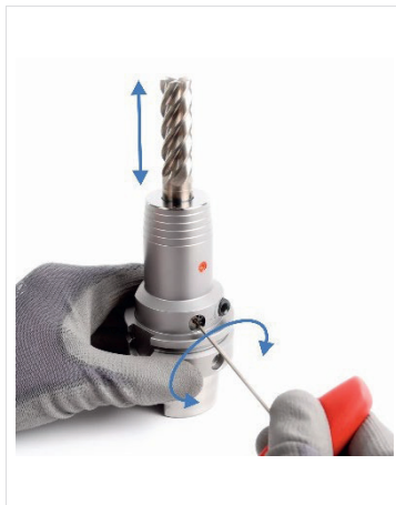
Abb. 11: Werkzeuglänge einstellen (radial)
