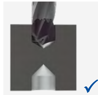
Durchbruch bei Gegenbohrung; v_f = -50\%
