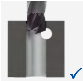
Bohrung außermittig; Querschnitte im Eingriff
