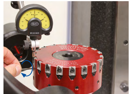
6. Posicionar o relógio comparador no inserto de fresagem ajustado e zerar. Ajustar os insertos de fresagem com o relógio comparador 0,01 mm antes da EM: Para isso girar o fuso de rosca com uma chave Allen no sentido horário até atingir a medida zero.
