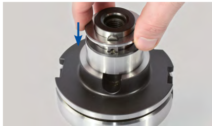
4. Encaixar o segundo anel distanciador sobre o primeiro anel distanciador e o mandril porta-fresas de encaixe.
