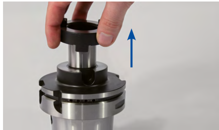
1. Retirar o anel de arraste do mandril porta-fresas de encaixe.
