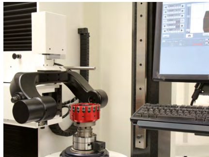
5. Com o dispositivo de ajuste, ajustar opticamente um inserto de fresagem -0,01 mm antes da medida de ajuste (EM). Para isso, envolver a aresta de corte com o dispositivo de medição ótica e, com uma chave Allen, girar o fuso de rosca no sentido horário até atingir EM = -0,01 mm. Para um ajuste puramente ótico, repetir este procedimento para os insertos de fresagem restantes (em seguida continuar com a etapa 7).
