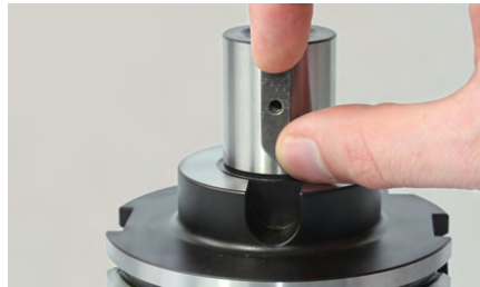
2. Inserir a chaveta no mandril porta-fresas de encaixe.
