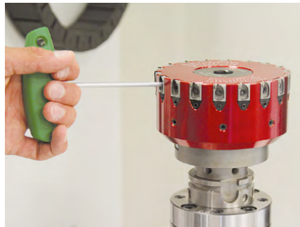
2. Soltar o parafuso de fixação do inserto de fresagem e retirar da guia tipo cauda de andorinha para cima.
