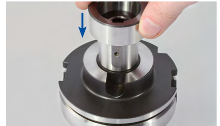
3. Encaixar o primeiro anel distanciador no mandril porta-fresas de encaixe.
