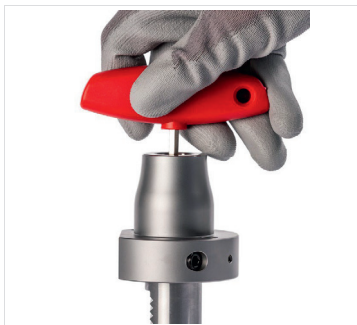
Abb. 8: Werkzeuglänge einstellen (axial)
