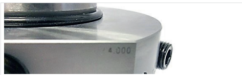
Abb. 5: Beschriftung zur Prüfung der Spannkraft
