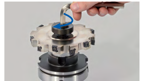
8. アレンキーを使ってミーリングカッターの締め付けねじをさらに時計回りに回してから、トルクレンチで締め付けます (締め付けトルクに関しては「ミーリングカッター締め付けねじ用トルク」表を参照)。
