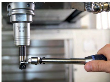
4. トルクレンチを可能な限り交換ミーリングヘッドに水平に置きます。その際レンチフラットで傾けないようにしてください。
