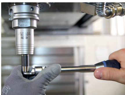
5. 注記: 繊細な調整ができるようにミリングヘッドに空いている手を置きます。これにより締め付けトルクをより正確に設定できます。
