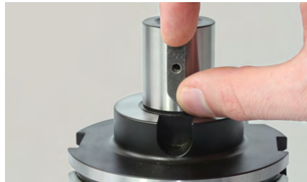
2. ミーリングカッターのアーバーに調整ばねを差し込みます。
