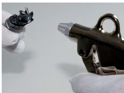
1. テーバの交換ミーリングヘッド、ネジ、接触面を圧縮空気と布で清掃します。
