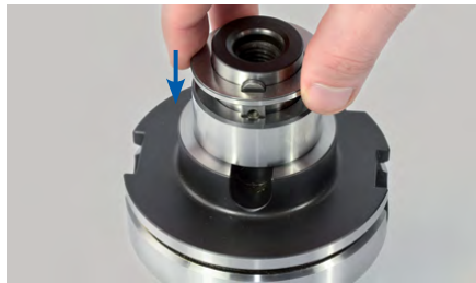
4. 2番目のスペーサーリングを1番目のスペーサーリングとミーリングカッターのアーバーに載せます。
