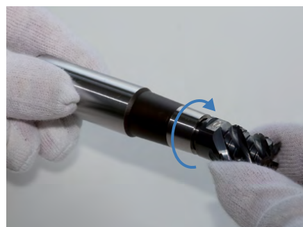
3. 交換ミーリングヘッドを時計回りにしっかり交換ヘッドホルダーにねじ込みます。次に交換ヘッドホルダーをツールと一緒にマシンホルダーに固定します。
