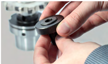
6. ねじきリングが1-2 mm突出するまでねじきボルトを回します。
