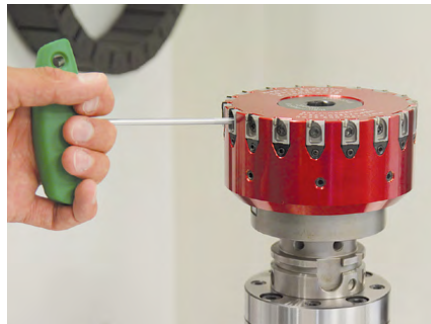
2. ミーリングカートリッジのクランプネジを緩め、ダブテールガイドから上に取り出します。
