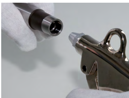
2. テーバの交換ヘッドホルダー、ネジ、接触面を圧縮空気と布で清掃します。
